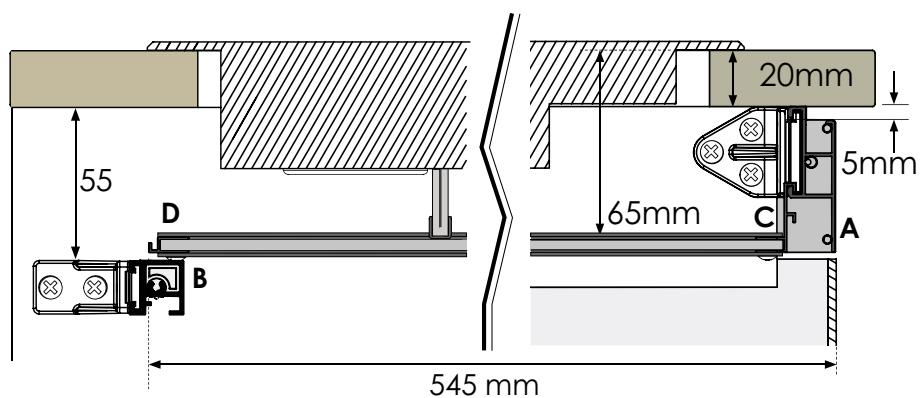
Colocar la bandeja ya montada en su posición enganchando el perfil **C** en el perfil Ventoo **A**. Dejar el perfil **D** apoyado sobre el perfil de refuerzo trasera **B**.
