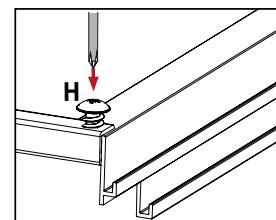
La bandeja de aislamiento reflexivo de aluminio **F** va enrollada en el sentido del ancho del mueble. Desenrollar y encajar el perfil **C** y **D** en la bandeja **F** (con los agujeros hacia arriba), en los bordes en el sentido en que venía enrollada. Encajar los perfiles **E** con los agujeros coincidiendo con los perfiles **C** y **D**, fijar con los tornillos **H**, y asegurar todos los perfiles con los adhesivos **G**.
