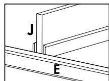
Compruebe donde tiene el ventilador su modelo de inducción y tome medida. Teniendo en cuenta esa medida, coloque los tornillos autotaladrantes **i** en la posición deseada. A continuación encaje por la cara contraria el separador **J** en el perfil **E**. Una vez en su sitio, fijar con los tornillos **i**. De este modo el ventilador de su inducción cogerá el aire frío y expulsará el caliente por la parte delantera.
