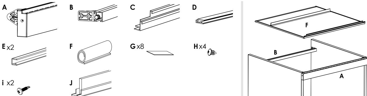
**A** Perfil Ventoo / **B** Perfil refuerzo trasera / **C** Perfil bandeja delantero / **D** Perfil bandeja trasero / **E** Perfil lateral bandeja / **F** Bandeja de aislamiento reflexivo de aluminio / **G** Aluminio adhesivo / **H** Tornillos / **I** Tornillo autotaladrante / **J** Separador
